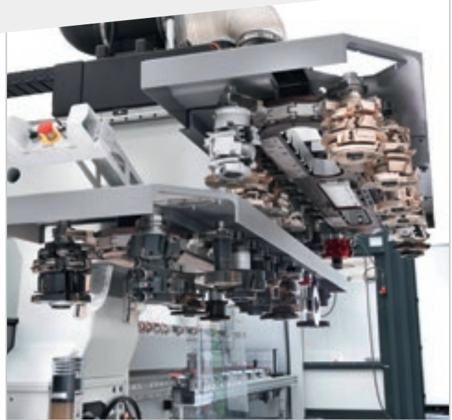
Almacén de cadena de doble nivel con 44 posiciones totales.
